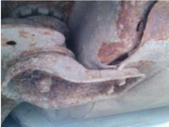
L'avancée dans la protection anticorrosion (blackson bitumeux remplacé par produit anti-gravillon synthétique) signifie que la 280ZX est théoriquement mieux protégée que la 240Z mais en pratique n'en sont pas exemptes. La zone sensible est la tôle du plancher qui tient les pattes de renfort de la traverse de train arrière. Une inspection est nécessaire en avançant les sièges et soulevant la moquette. Les
